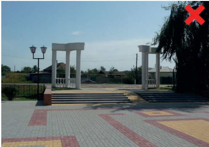
Как показывает практика, применение пестрой цветной плитки в мощении, в большинстве случаев, не красит объекты благоустройства.
